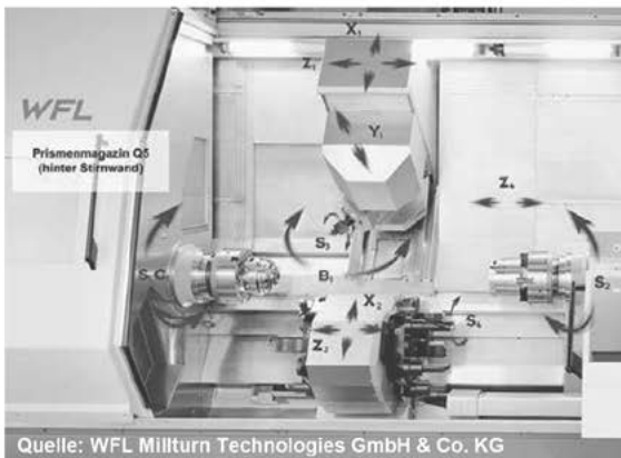
Bild 1: Achsschema einer Werkzeugmaschine
